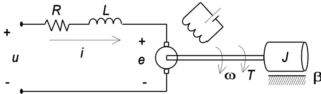
Circuito do rotor do motor:
