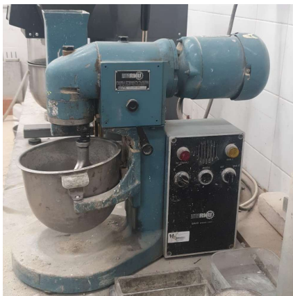
Figura 20 - Misturadora para produção de CC
