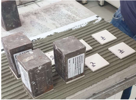
Figura 31 - Ensaio de Pull-off. Aplicação de ladrilhos cerâmicos
