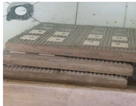
Figura 34 - Ensaio de Pull-off após envelhecimento por imersão.
