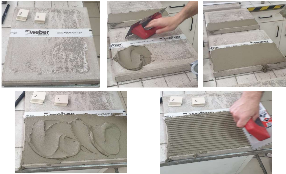
Figura 24 – Preparação para ensaio de transferência e poder molhante: i) Placa de betão de base; ii) aplicação da primeira camada; iii) base para a segunda camada; iv) aplicação da segunda camada; v) Denteamento da segunda camada (de cima para baixo e da esquerda para a direita)
