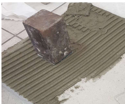
Figura 25 - Ensaio de transferência e poder-molhante. Aplicação do peso sobre a chapa de vidro
