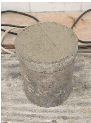
Figura 22 - Determinação da massa volúmica no estado fresco
