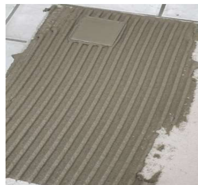
Figura 26 - Ensaio de transferência e poder molhante. Chapa e vidro após remoção do peso.
