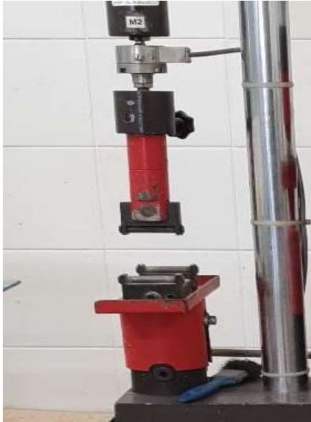
Figura 29 - Ensaio à flexão
