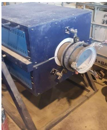
Figura 18 - Forno rotativo para Termoativação do CR
