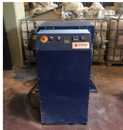
Figura 18 - Forno rotativo para Termoativação do CR
