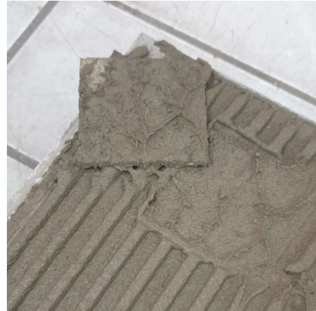
Figura 28 - Ensaio de transferência - avaliação da quantificação de material transferido para o vidro.
