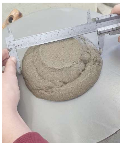
Figura 23 - Ensaio de espalhamento
