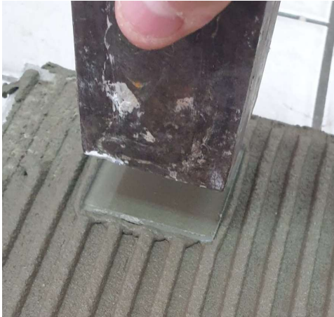
Figura 27 - Ensaio de transferência e poder movente - remoção do peso
