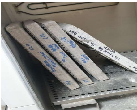
Figura 33 - Ensaio de Pull-off após envelhecimento por calor.
