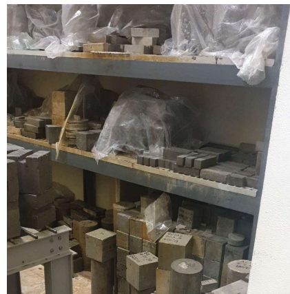
Figura 21 - Camara húmida para condicionamentos dos provetes
