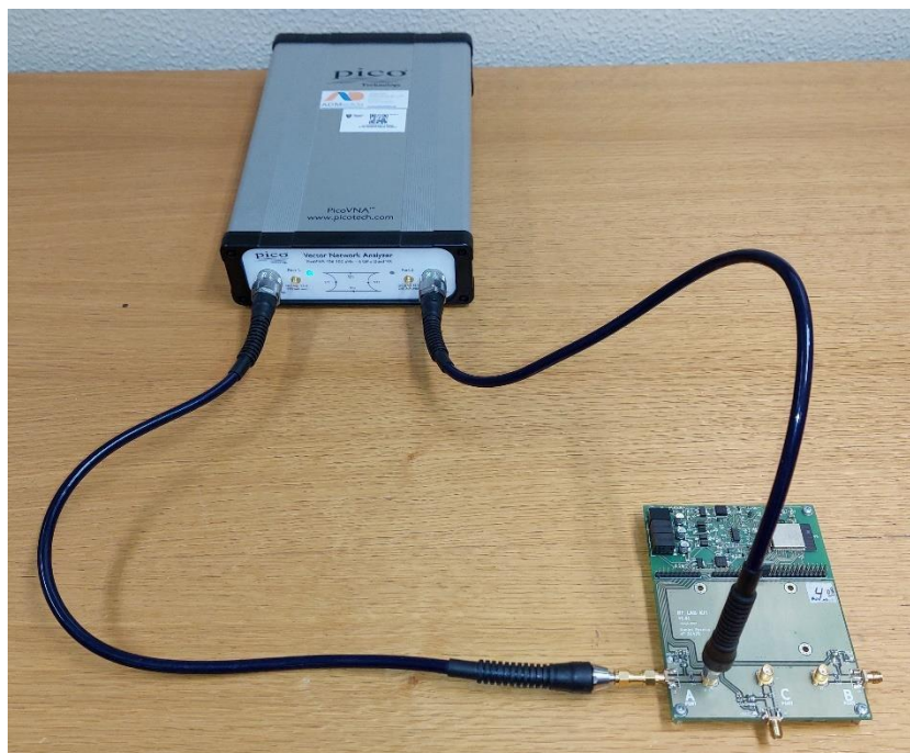
Figura 54 – Montagem de medida to T de alimentação da placa modular.
