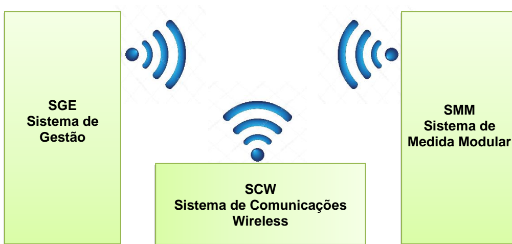
Figura 6 – Estrutura geral do sistema de demonstração.
