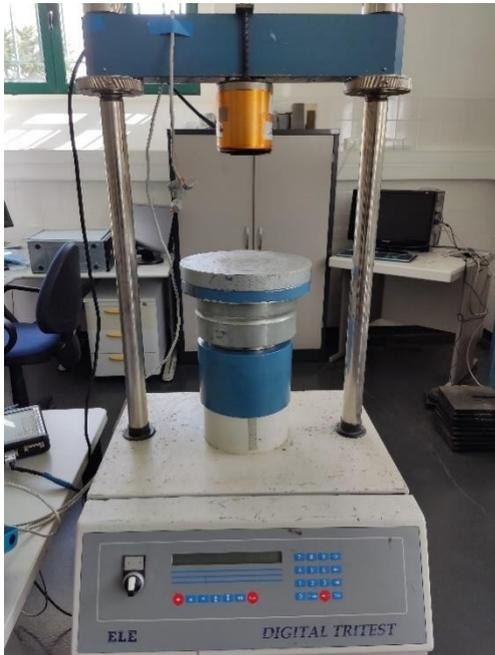
Figura 31- prensa ELE utilizada nos ensaios de resistência à compressão uniaxial
