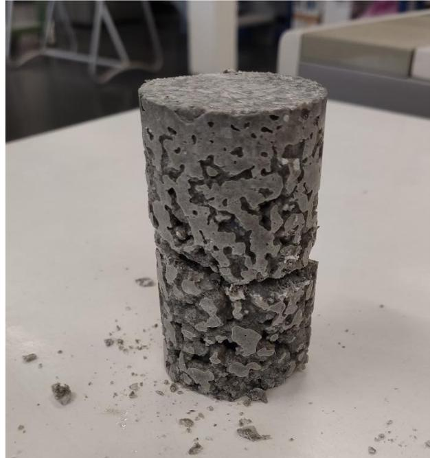
Figura 47 - Provete de enchimento rochoso cimentado depois de submetido ao ensaio de corte II
