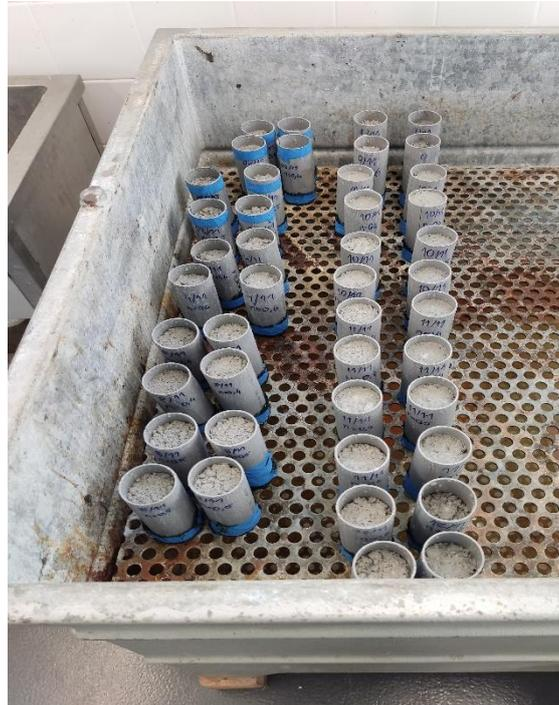
*Figura 29 - Provetes colocados na Câmara Húmida a 28°C*
