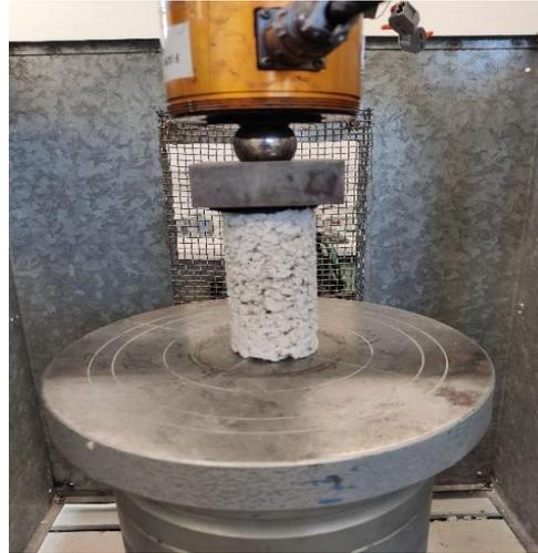
Figura 34 - Prensa e provete em ensaio de compressão uniaxial
