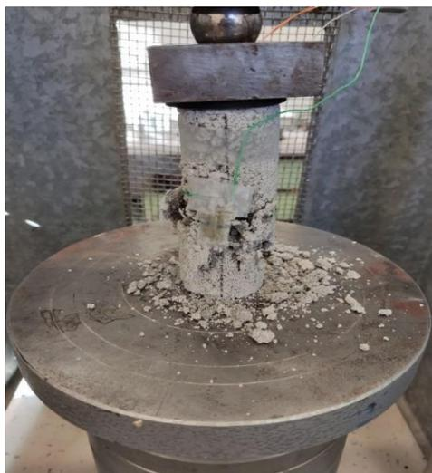
Figura 42 - Provete de enchimento rochoso cimentado após ensaio de compressão uniaxial
