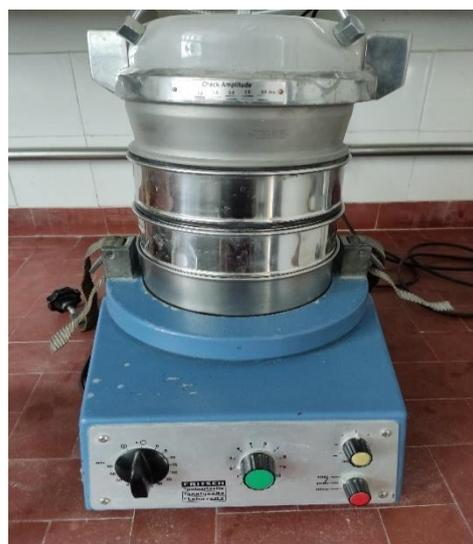
Figura 25 - Agitadora FRITSCH analvsette
