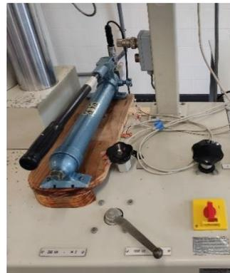
Figura 36 - Macaco Hidráulico ELE
