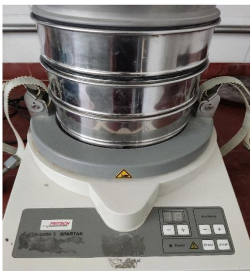
Figura 24- Agitadora FRITSCH analvsette 3
