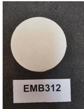
*Figura 14 - Amostra antes do ensaio Brasileiro*
