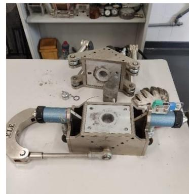
Figura 37 - equipamento de corte direto ELE
