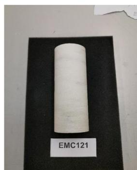
*Figura 16 - Amostra antes do ensaio de compressão uniaxial*
