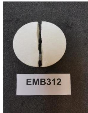
*Figura 15 - Amostra depois do ensaio Brasileiro*
