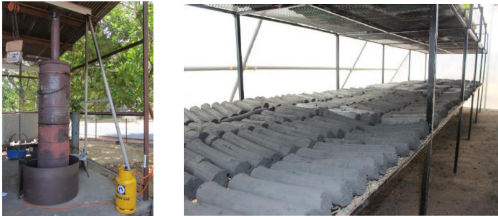
Figura 3-9: Reator de Duplo Barril (esquerda) [32] e pellets de LF carbonizadas (direita) [28].
