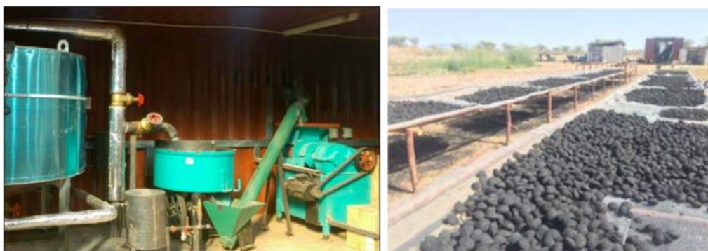
Figura 4-5: Parte da linha de tratamento de uma unidade de produção de briquetes (esquerda) e secagem solar dos briquetes (Direita) [18].
