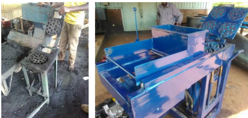
Figura 3-10: Exemplos de compactadores, de funcionamento manual, à esquerda, e automática, à direita. [28]
