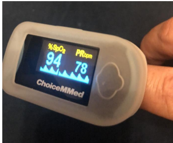
Figura 3 - Oxímetro onde são mostrados os parâmetros da oxigenação do sangue e da frequência cardíaca
