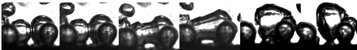
Figura 4.15: Fenómeno de coalescência entre bolhas na superfície.
