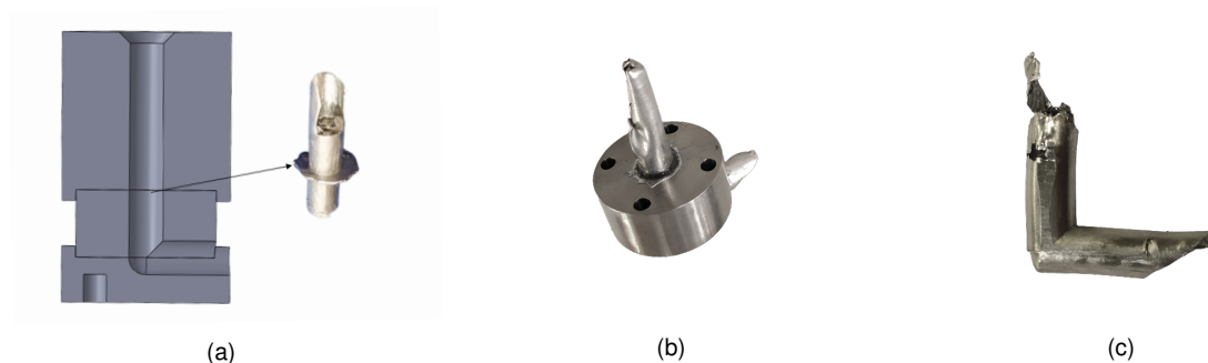
Figura 3.15: Material apresentando escoamento por entre os módulos da matriz e extrusão inversa. (a) Provete retirado da matriz a meio de um ensaio; (b) Material num dos módulos da matriz durante o ensaio; (c) Provete apresentando extrusão inversa na parte superior.
