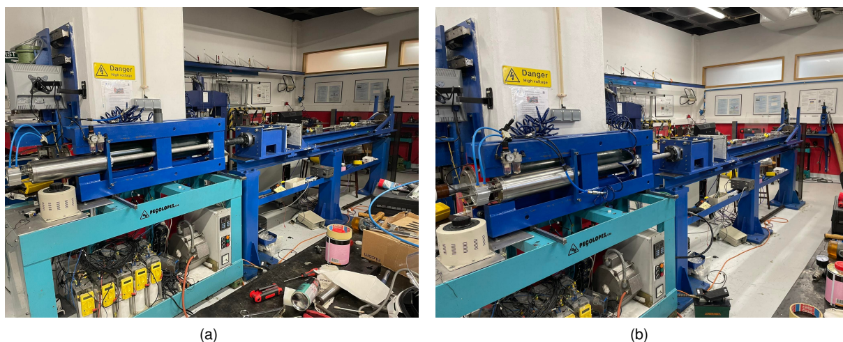
Figura 3.15: Configuração final do aparato experimental: (a) Ensaios Quasi-estáticos, (b) Esaios Dinâmicos
