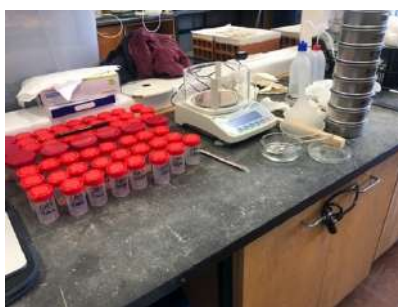
Figura 4.22 Pormenor da organização da mesa de trabalho para a metodologia de peneiração.
