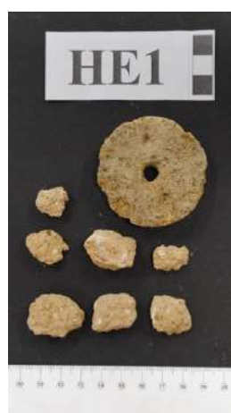
Figura 5.10 Amostra de HE1, face interior, e nódulos de cal em diversos fragmentos.
