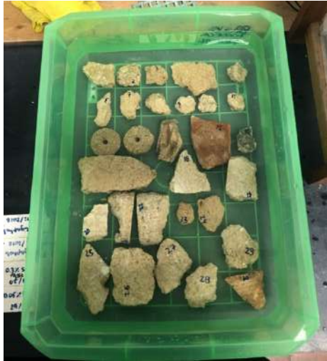
Figura 4.29 Amostras imersas em água para determinar teor em água após 48 horas.
