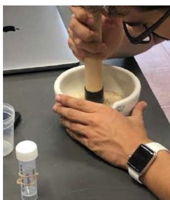
Figura 4.17 Pormenor do processo de moagem dos constituintes da amostra.
