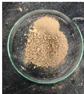
Figura 4.21 Pormenor da amostra completa, com as partículas mais finas visíveis na zona superior da placa de Petri.
