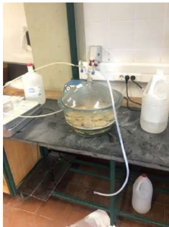
Figura 4.27 Introdução de ar para estabilização à pressão atmosférica.
