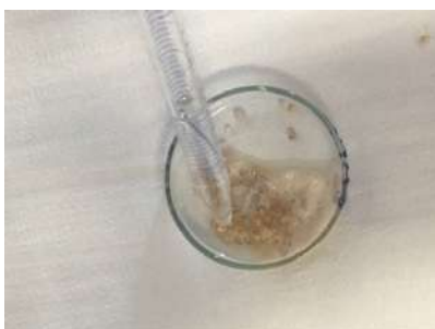
Figura 4.15 Teste com reactividade às gotas de ácido clorídrico.
