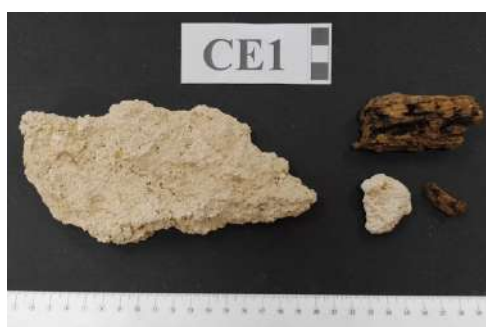
Figura 5.9 Amostra CE1, face interior, com alguns vazios e nódulos de cal.
