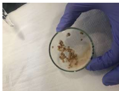
Figura 4.16 Teste com baixa reactividade às gotas de ácido clorídrico.
