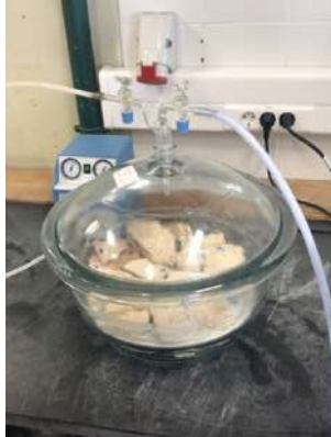
Figura 4.25 Exsiccador com amostras em vácuo.
