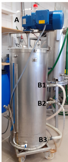
Figura 3.16: Reator utilizado para a extração do ensaio piloto. A: motor de agitação; B1-3 válvulas de descarga.
