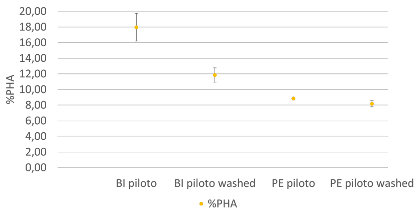
Figura 3.18: Resultados da quantificação de PHA da extração à escala piloto e da lavagem das amostras, na Figura identificadas com o sufixo washed .
