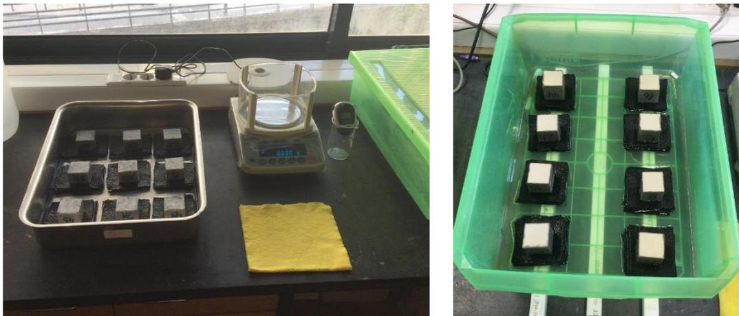
*Figura 4.5 - Provetes colocados sobre o geotêxtil durante o ensaio.*
