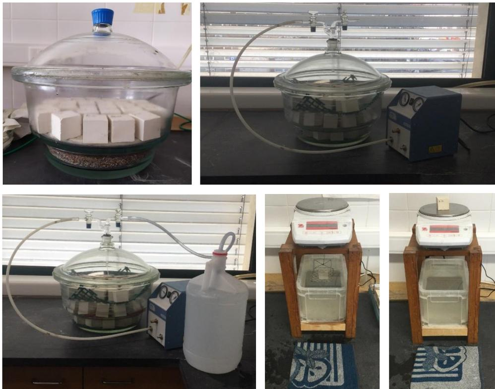
**Figura 4.4** - Passos para a determinação da porosidade aberta, massa volúmica real e aparente.
