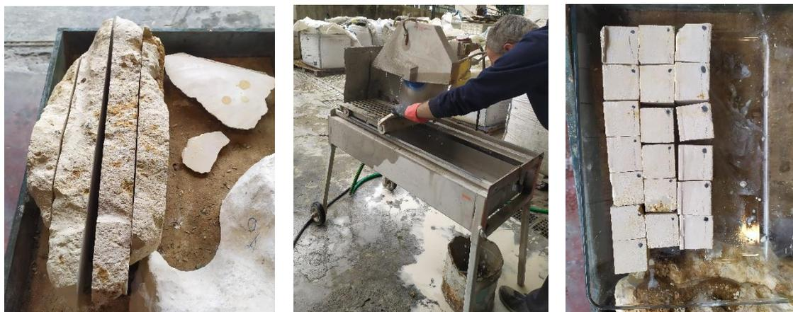
Figura 4.1 - Corte dos blocos e provetes.
