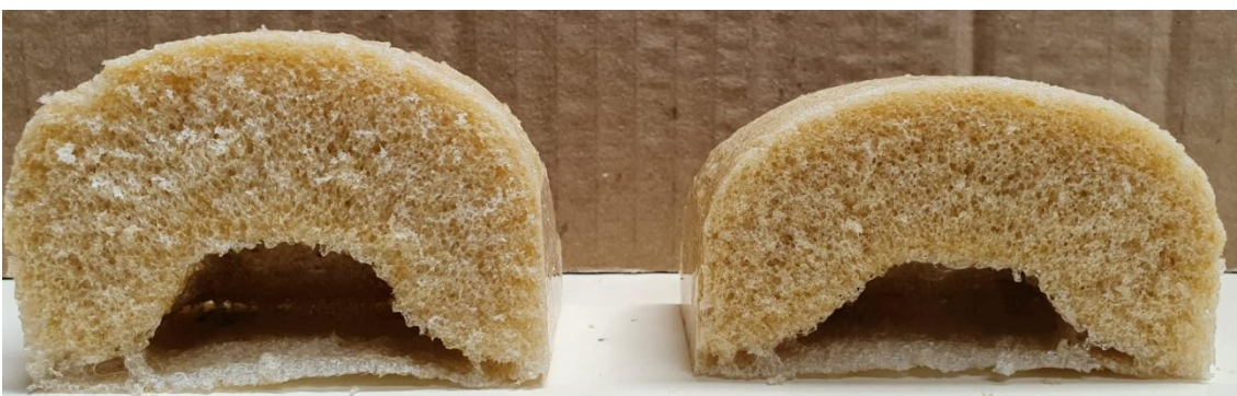
Figura 47. Espumas com diluição DABCO 33-LV em \frac{1}{2} e \frac{1}{4} , respectivamente
