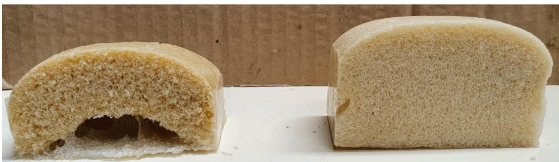
Figura 48. Espumas com diluição do DABCO em \frac{1}{8} e \frac{1}{10} , respectivamente
