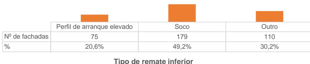
Figura 3.10 - Histograma com a distribuição dos tipos de remate inferior das fachadas da amostra inicial.
