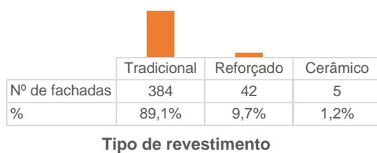
Figura 3.22 - Histograma com distribuição dos tipos de revestimento dos edifícios da amostra final.
