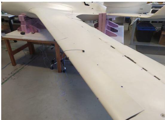
(d) Marks and sensors on wing.
