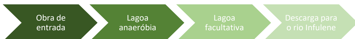
Figura 3.10 - Esquema do tratamento da ETAR do Infulene
