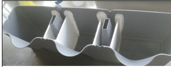
Figura 10 - Adaptação feita para isolamento entre potes.
