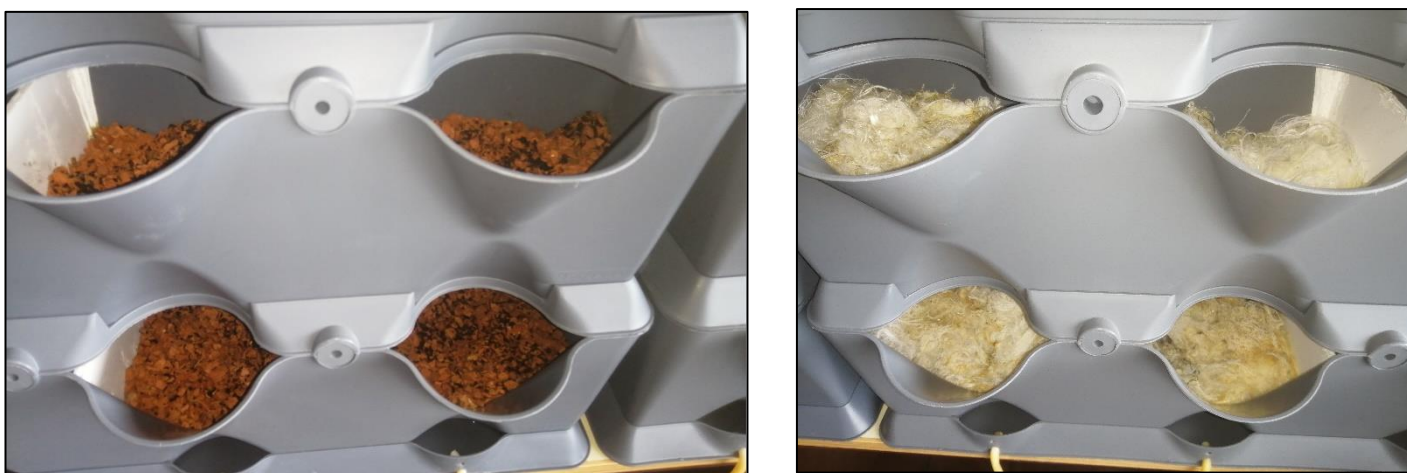
Figura 12 - Meio de enchimento em telhas cerâmicas e fibras de coco (esquerda) e meio de enchimento em fibras têxteis (direita).
