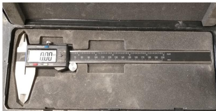
Figura 2.13 - Paquímetro utilizado nas medições dos provetes e moldes
