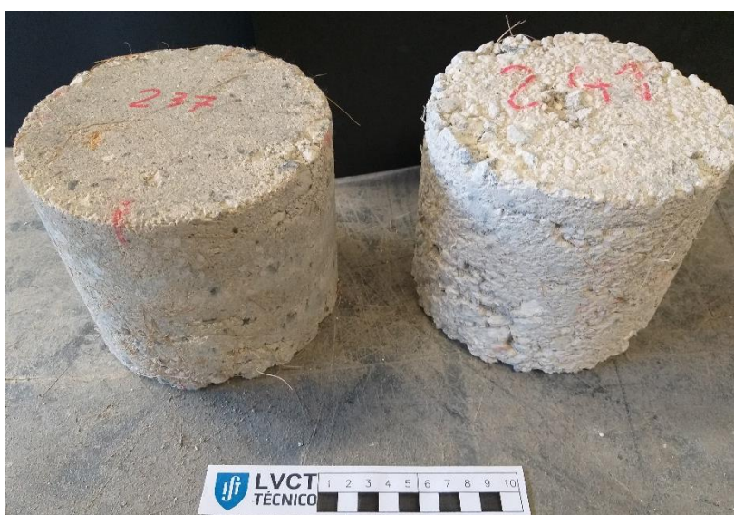
Figura 3.8 - Comparação entre o provete de controlo (esquerda) e o provete de escovagem (direita) para a mistura de RCD com 3% cimento com fibra
