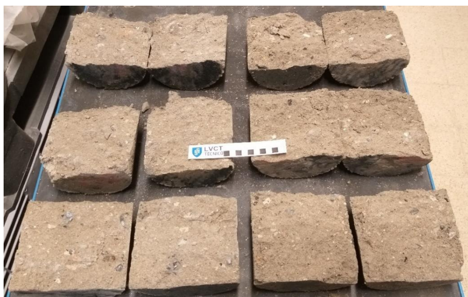
Figura 3.13 - Estado dos provetes húmidos (esquerda) e imersos (direita) da mistura de RCD com 2% de cimento sem fibra
