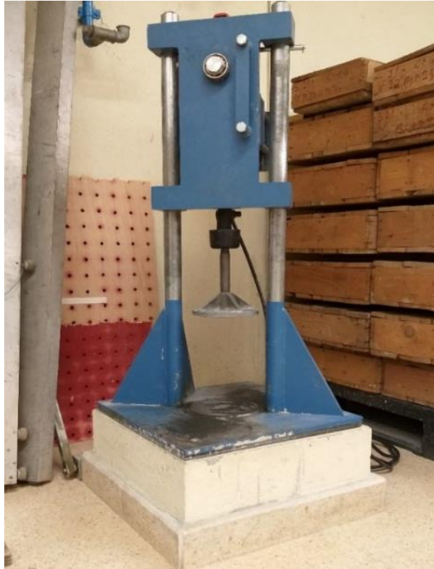
Figura 2.10 - Martelo Vibro Compactador utilizado na compactação dos provetes
