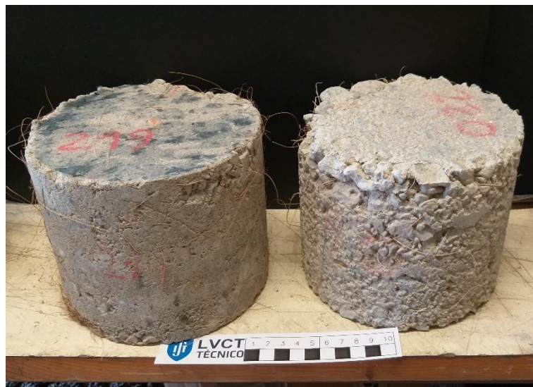
Figura 3.4 - Comparação entre o provete de controlo (esquerda) e o provete de escovagem (direita) para a mistura de RCD com 2% cimento com fibra
