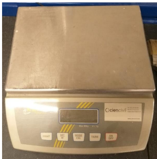
Figura 2.6 - Balança utilizada para medição de agregado
