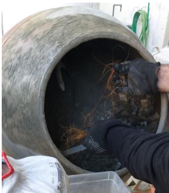
Figura 2.9 - Betoneira utilizada na junção dos materiais
