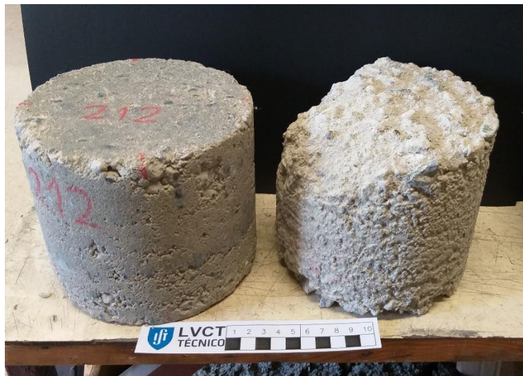
Figura 3.2 - Comparação entre o provete de controle (esquerda) e o provete de escovagem (direita) para a mistura de RCD com 2% cimento sem fibra
