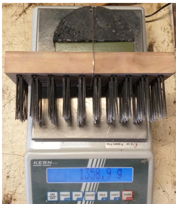
Figura 2.14 - Peso da escova utilizada na escovagem dos provetes
