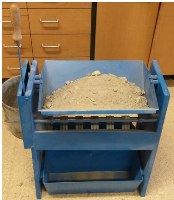
Figura 2.5 - Esquartelador utilizado no tratamento do agregado
