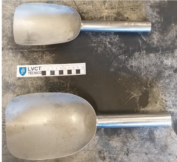
Figura 2.4 - Pás utilizadas no manuseio do agregado
