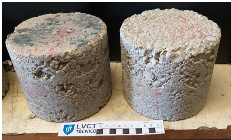
Figura 3.6 - Comparação entre o provete de controlo (esquerda) e o provete de escovagem (direita) para a mistura de RCD com 3% cimento sem fibra
