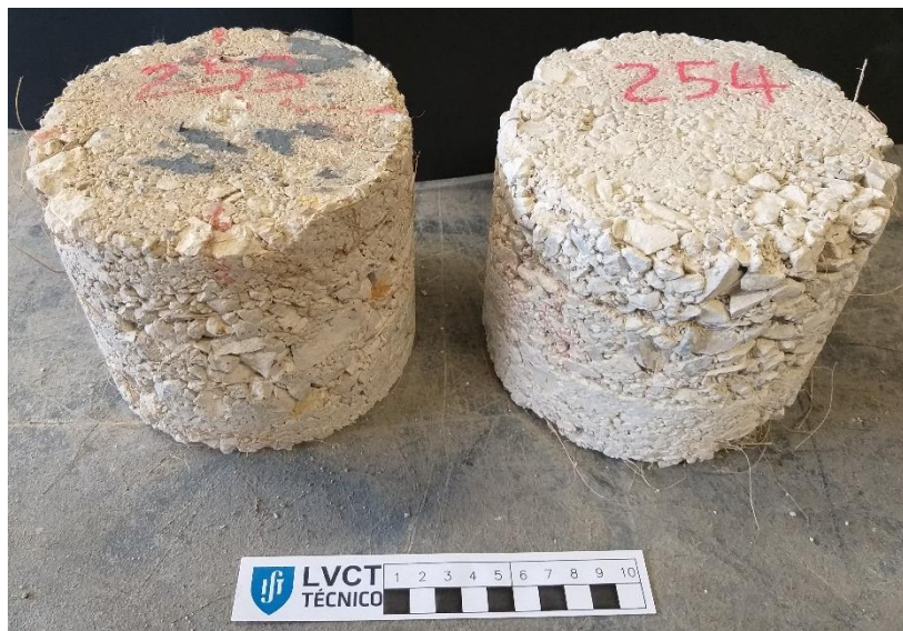
Figura 3.12 - Comparação entre o provete de controlo (esquerda) e o provete de escovagem (direita) para a mistura de calcário com 2% cimento com fibra
