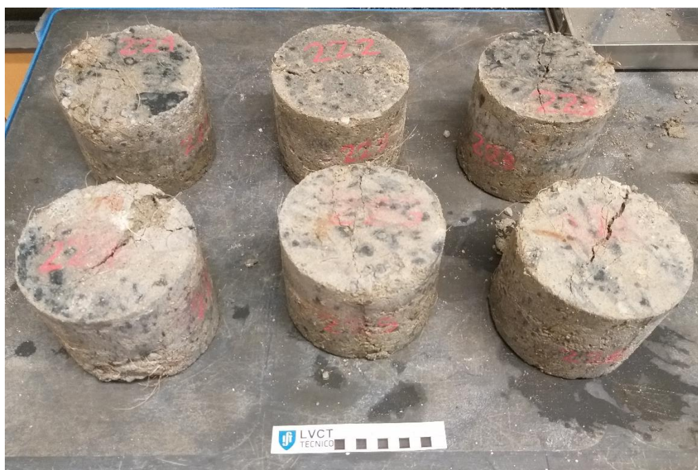
Figura 3.14 - Estado dos provetes húmidos (fila inferior) e imersos (fila superior) da mistura de RCD com 2% de cimento com fibra
