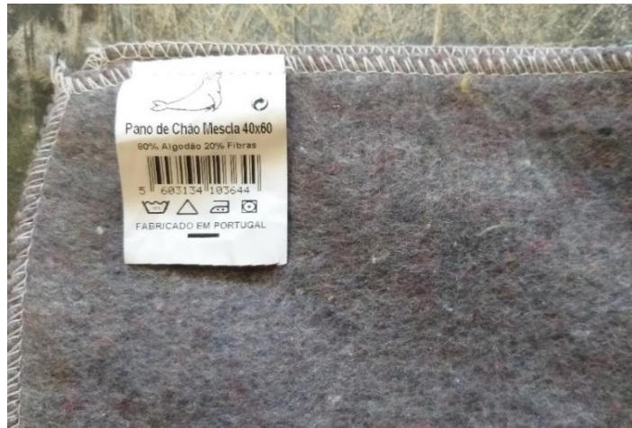
Figura 2.12 - Características dos panos utilizadas para manter a humidade no provete
