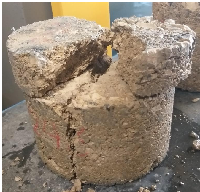
Figura 3.17 - Estado de uma provete relativo à mistura de calcário com 2% de cimento sem fibra de coco
