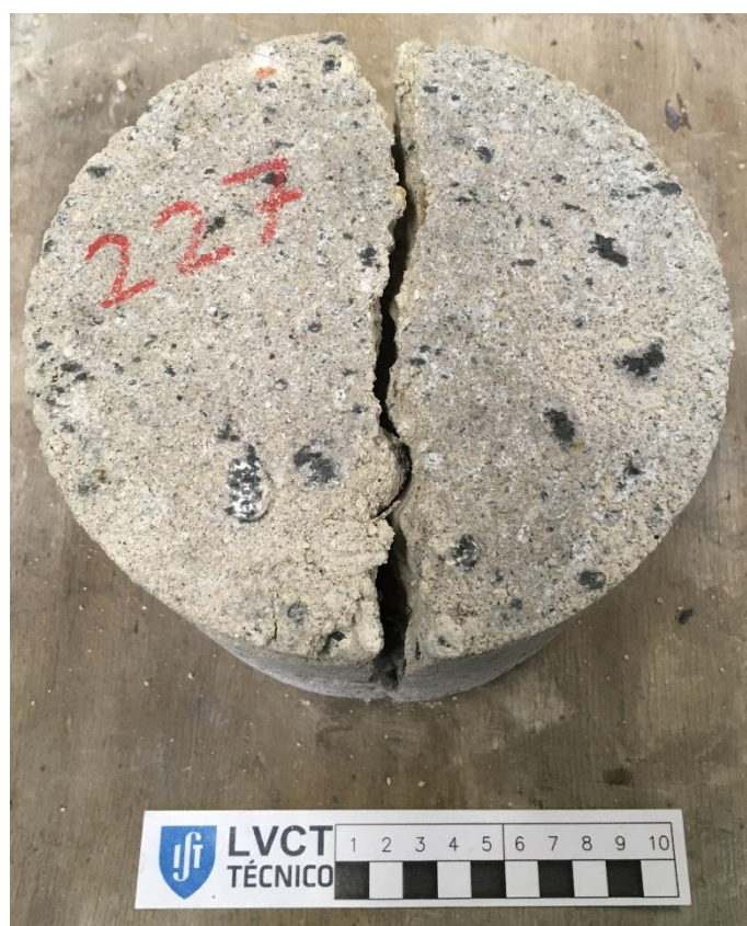
Figura 3.15 - Estado de um provete húmido da mistura de RCD com 3% de cimento sem fibra
