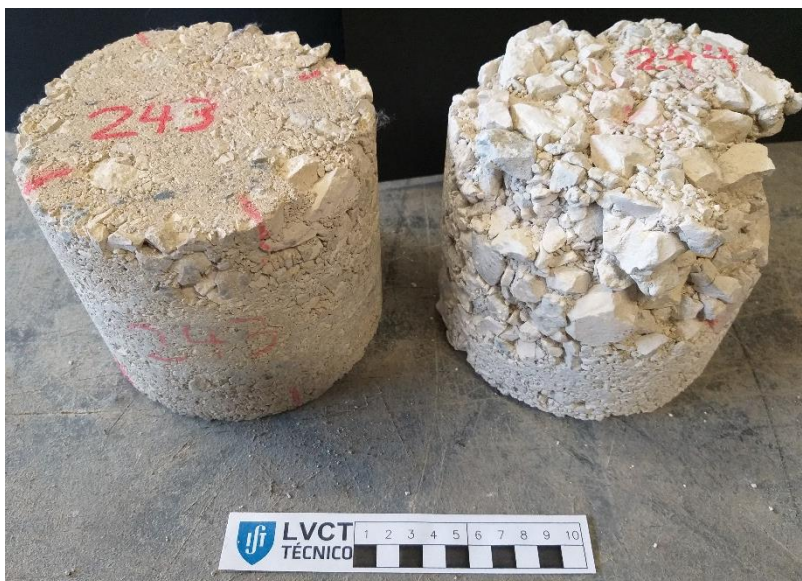
Figura 3.10 - Comparação entre o provete de controlo (esquerda) e o provete de escovagem (direita) para a mistura de calcário com 2% cimento sem fibra
