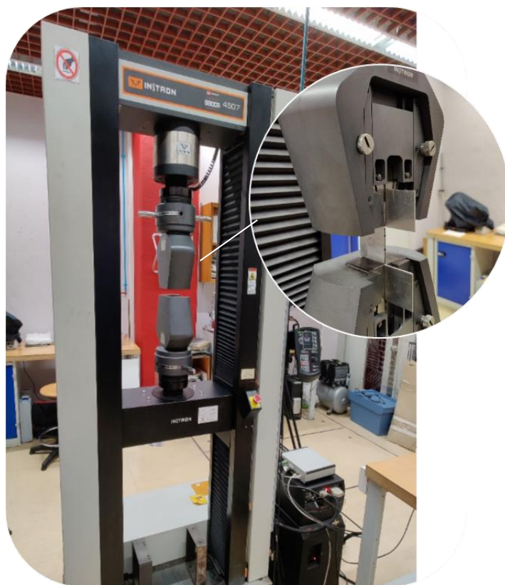
Figura 8. Máquina de ensaios utilizada e configuração utilizada para testar o desempenho das ligações produzidas.
