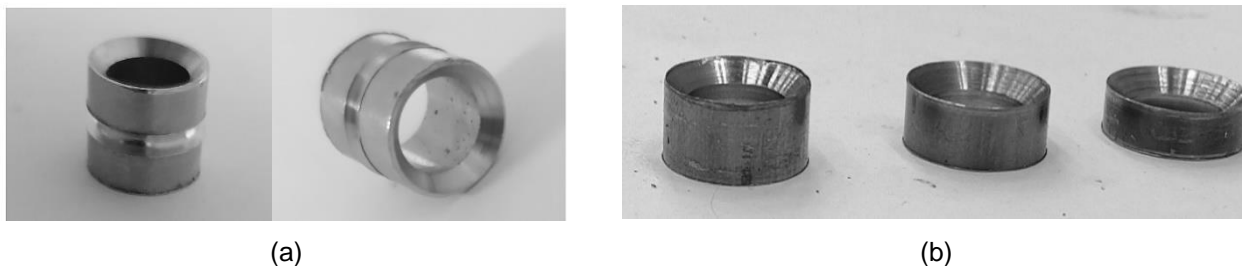
Figura 6. Exemplo de rebites produzidos com entalhes (a) e com diferentes reduções de altura inicial (b).
