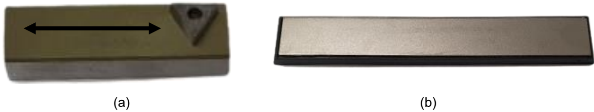
Fig. 4.18 – Pedras de polir e direção das passagens efetuadas com as ferramentas. (a) Pedra de polir de 6000; (b) Pedra de polir de 2000.
