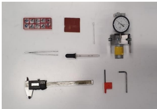
Fig. A3 – Conjunto de instrumentos e utensílios necessários no interior da câmara para a realização dos ensaios de corte ortogonal.
