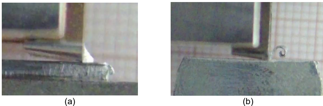
Fig. 4.26 – Formação de diferentes aparas num ensaio de corte ortogonal. (a) Apara com geometria indesejável (AA1085, encruado, V_c = 45 mm/min, w_a = 1.4 mm, árgon, Wc-Co, R_a \approx 0.01 \mu m); (b) Apara com a geometria desejada (zinco puro, encruado, V_c = 45 mm/min, w_a = 1.03 mm, árgon, Wc-Co, R_a \approx 0.01 \mu m).
