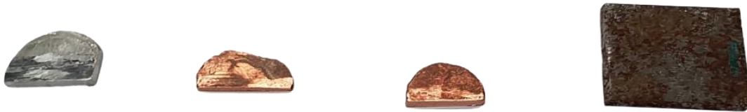
Fig. 4.25 – Aspeto de alguns dos materiais ensaiados: liga de Alumínio AA1085; cobre puro (proвете encruado); Cobre puro (proвете recozido); Aço maraging 18Ni 300 grade por fabrico aditivo (ordem da esquerda para a direita).
