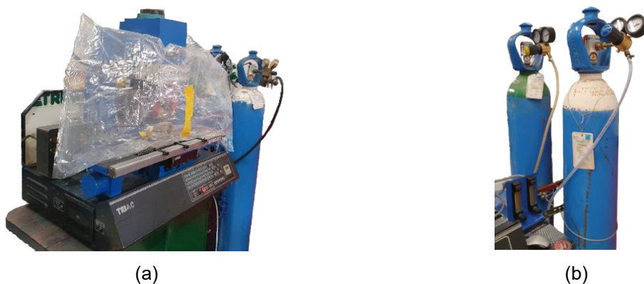
Fig. 3.4 – Equipamentos constituintes do aparato experimental. (a) Câmara de controlo da atmosfera; (b) Reservatórios de Árgon e Oxigénio com redutores de pressão instalados.
