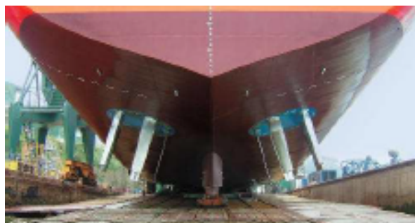
(b) Hélices de Voith-Schneider instaladas em um navio.
