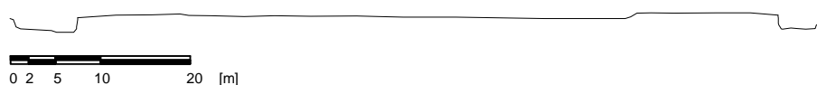
Figura 3.3 – Perfil longitudinal ao longo do eixo do coroamento e descarregadores de cheias da barragem do Monte Branco, no alinhamento com esse eixo.
