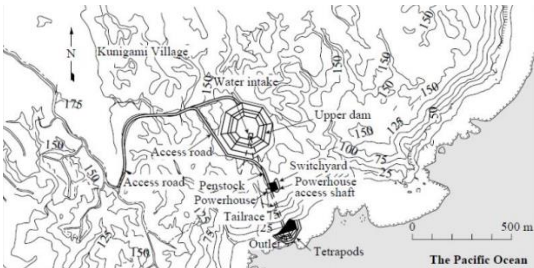
Figura 9 – Planta da CHR de Okinawa Yanbaru no Japão (Oshima et al. 1998)
