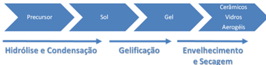
Figura 2: Esquema das diversas fases do processo sol-gel.
