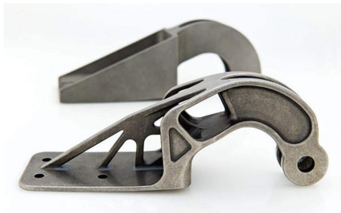
Figura 9 - Exemplo de uma peça de suporte produzida através de manufatura aditiva e com um design biomimético em comparação com uma peça pelos métodos convencionais. Fonte: (Sander, 2015).
