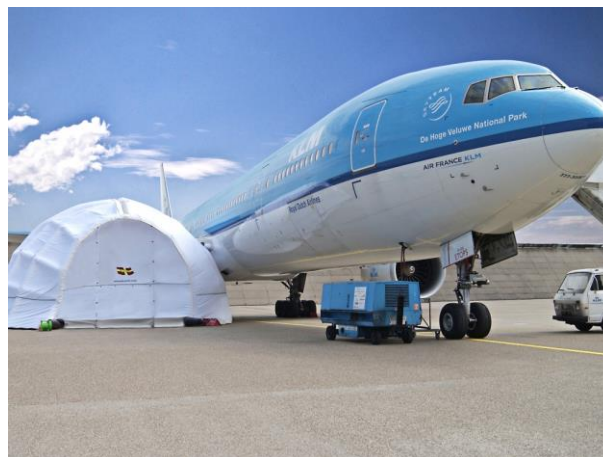
Figura 13 - Tenda insuflável para manutenção exterior de motores. Fonte: (Baticon-Ramos & Fendall, 2015)
