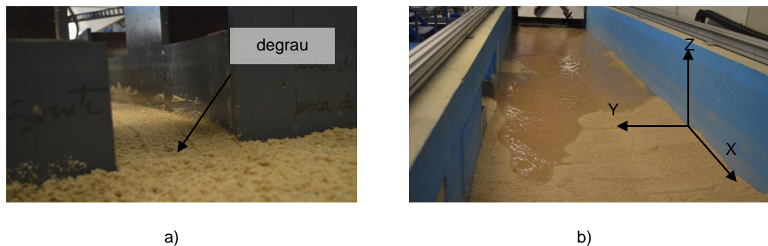
Figura 3.13: a) confluência entre canais em que se observa a presença do degrau; b) canal principal durante a fase de enchimento do canal.
