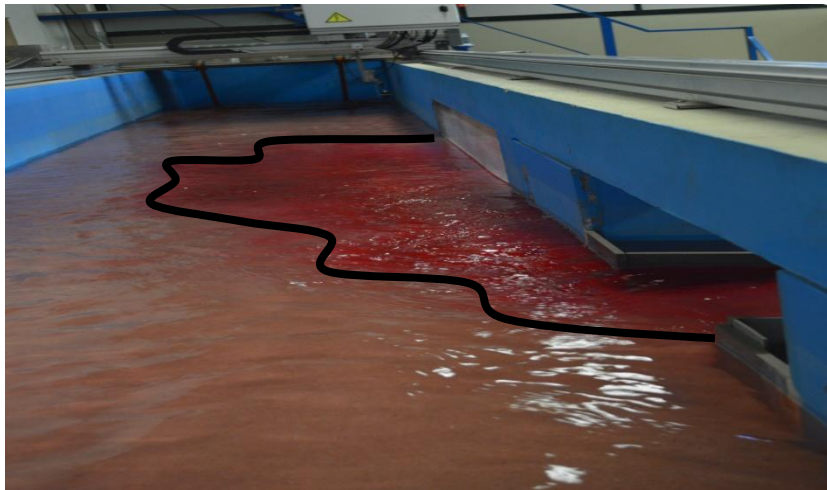
Figura 4.15: Imagem dos escoamentos confluentes com presença de corante.
