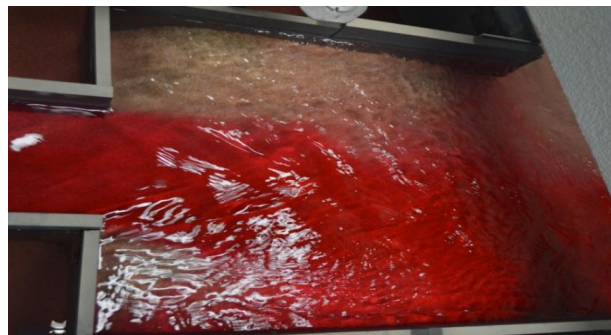
Figura 4.16: Imagem da dispersão do corante no canal afluente.
