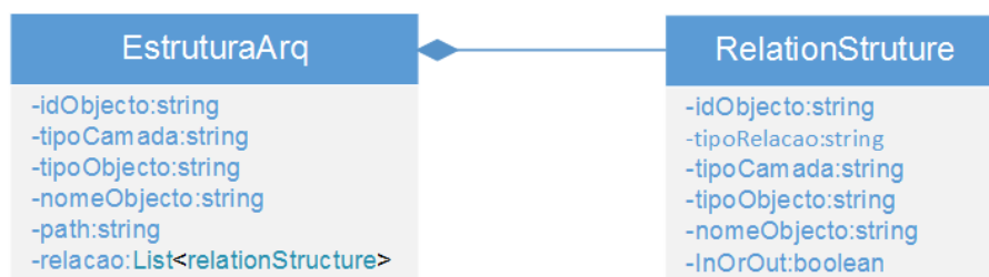
Figura 5.2: Diagrama de classes da estrutura da informação guardada
