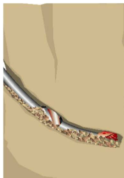
Figura 2.6 – Aprisionamento do equipamento de perfuração devido a deficiente limpeza do furo (adaptada de Bowes e Procter, 1997).
