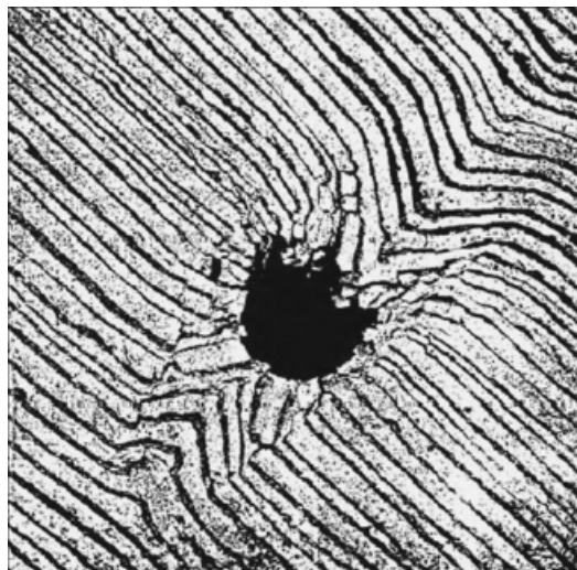
Figura 2.8 – Rotura num poço perfurando estratos inclinados e finamente estratificados (adaptada de Zhang, 2012, baseado em Bandis, 2011).
