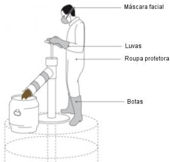
Figura 3.5: Exemplo de funcionamento de sistema de bombagem manual, através de movimento vertical. Adaptada de Stauffer et al. (2014).
