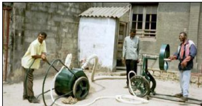
Figura 3.6: Exemplo de uso de MAPET no Congo, para coleta manual de lamas fecais. Retirada de Stauffer et al. (2014).
