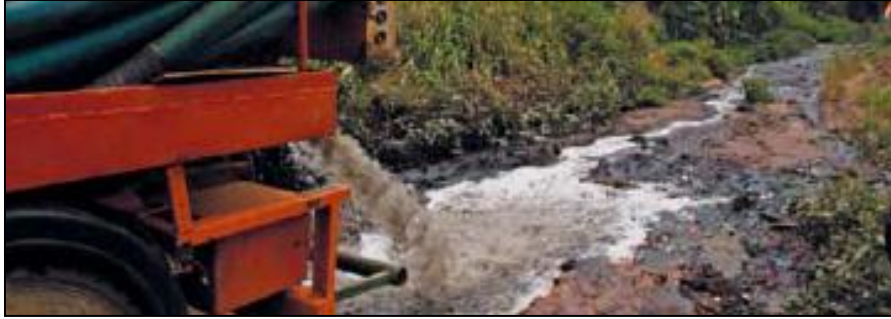
Figura 2.9: Exemplo de descarga indevida direta no meio ambiente em Yaoundé, Camarões. Retirada de Strande, et al. (2014).
