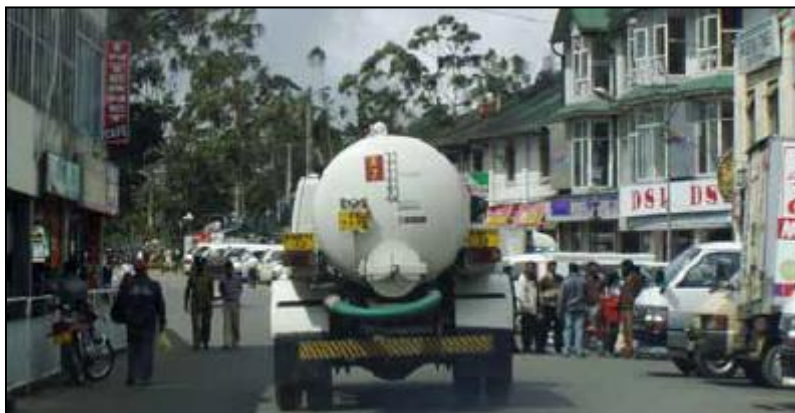
Figura 3.9: Camião de coleta e transporte de lamas fecais da cidade de Manila, nas Filipinas. Retirada de Strande et al. (2014).
