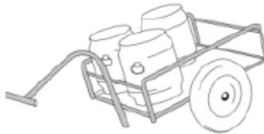
Figura 3.10: Exemplo de transporte manual de contentores de lamas. Retirada de Stauffer et al. (2014).
