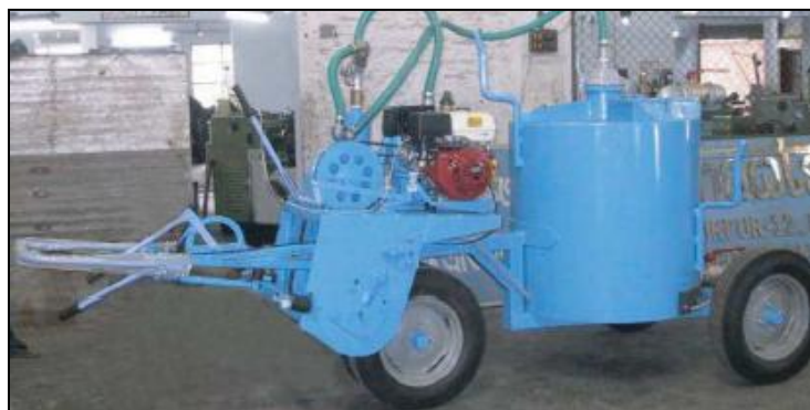
Figura 3.8: Vacutug criado pelo UN-HABITAT. Retirada de Still & Foxon (2012).
