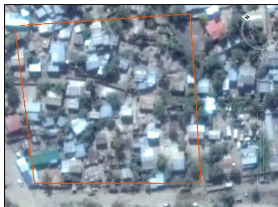
Figura 4.9: Imagem de malha urbana desordenada menos densa, no centro do Espaço Urbano, com delimitação de 1 hectare (100x100m) para o cálculo de densidade populacional. Adaptada de 'Google Earth'.
