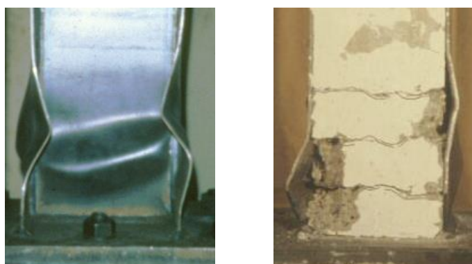
FIGURA 2.8 – MODO DE ENCURVADURA DE UMA COLUNA DE AÇO (PARA DENTRO E FORA DO PLANO DA CHAPA) E DE UMA COLUNA MISTA AÇO-BETÃO (PARA FORA DO PLANO DA CHAPA)
