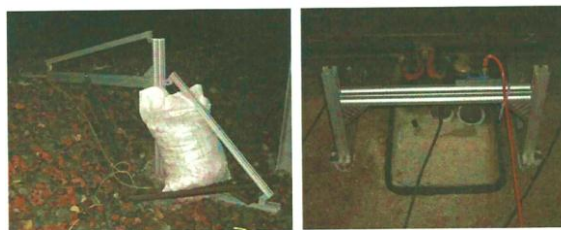
Figura 5.5: Sistema de medição de deslocamentos na via balastrada (esquerda) e via em laje de betão (direita) (SNCF, 2012)
