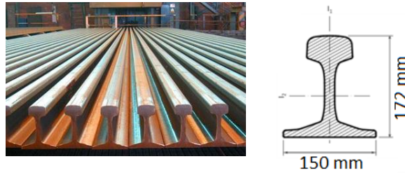
Figura 2.4: Fabrico (esquerda) e propriedades do carril UIC60 (direita)
