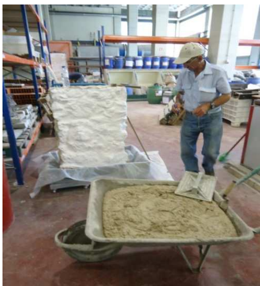
Figura 3.39 – Argamassa de cal hidráulica e areia.
