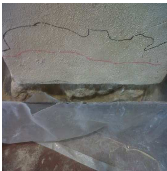
Figura 3.33 – Pormenor de corte do reboco na base do provete
