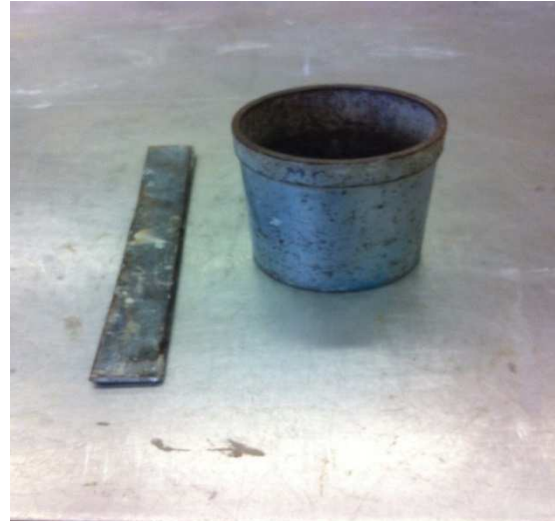
Figura 3.26 – Provete p/ determinação da baridade.
