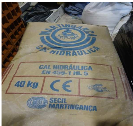
Figura 3.3 – Cal hidráulica natural (NHL 5).
