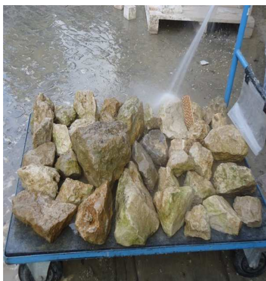
Figura 3.2 – Lavagem com jacto de água.
