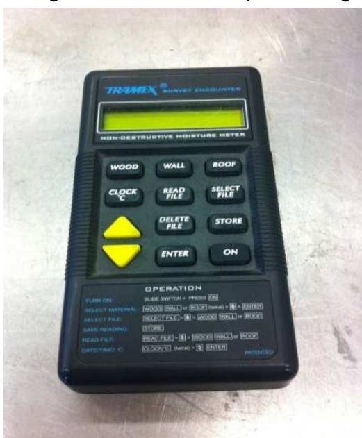
Figura 3.47 – Humidímetro de contacto “Tramex”.
