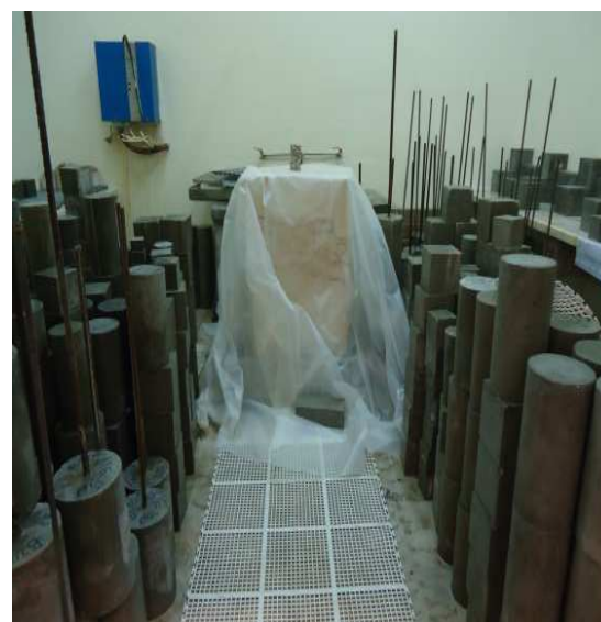
Figura 3.34 – Proteção do provete com manta de plástico.
