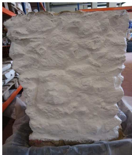
Figura 3.38 – Progresso na aplicação de tinta de borracha.
