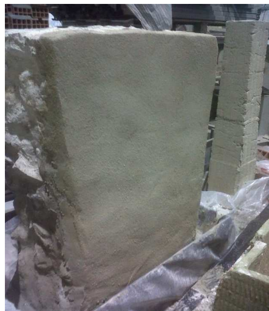
Figura 3.28 – Reboco com 0,03 m de espessura média na face de maior dimensão (face “A”).
