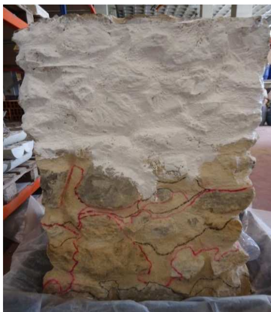
Figura 3.37 – Aplicação da 1ª. demão de tinta de borracha.
