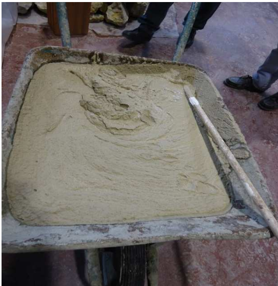
Figura 3.7 – Argamassa de cal natural e areia.
