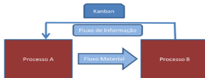
Figura 7 – Representação esquemática do funcionamento do sistema Kanban
