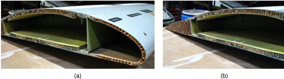
Figura 2.5: Asa constituída por painéis em sanduíche com núcleos *honeycomb*. (a) Bordo de ataque. (b) Bordo de fuga [17].
