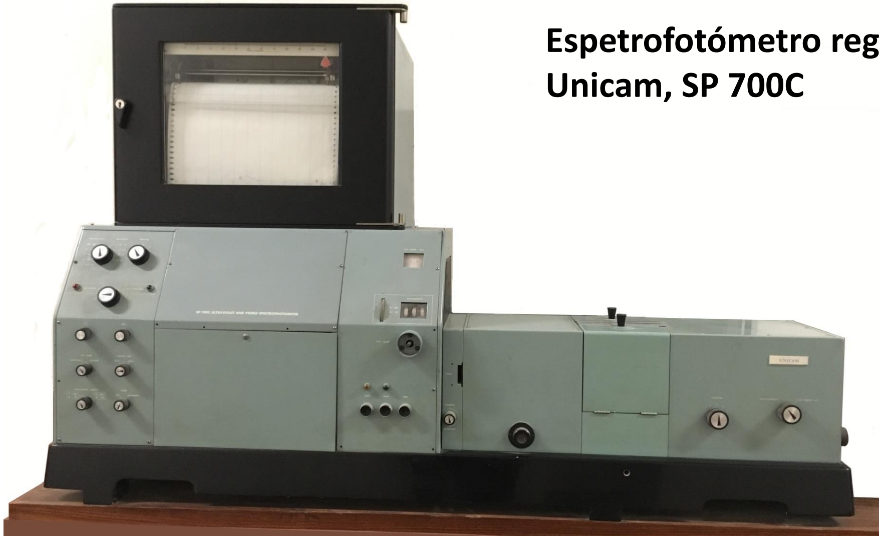
Figura 1 - Espectrofotômetro registrador UV/Vis, Unicam, SP 700C, (Unicam Instruments, Limited, Cambridge, England). Esteve em uso no Laboratório de Química Física e atualmente pertence à coleção de instrumentos antigos didáticos e de investigação do IST-DEQ.
