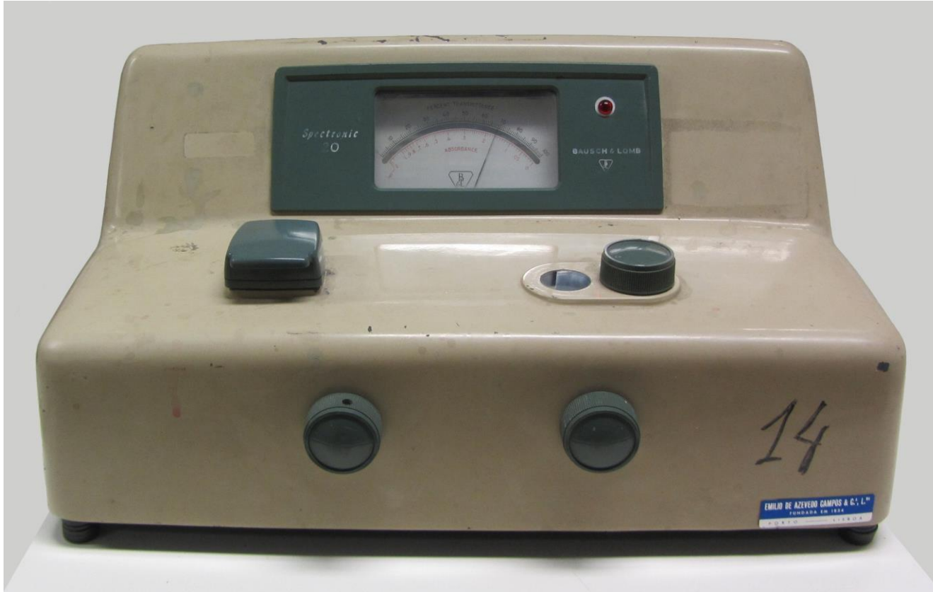
Figura 1 – Spectronic 20. Espectrofotômetro de feixe simples desenvolvido por Bausch & Lomb e lançado em 1953, existente na coleção de instrumentos antigos didáticos e de investigação do Lab. Química, Instituto Superior Técnico.
