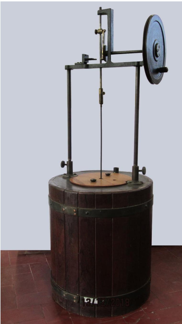
Figura 1 - Calorímetro de combustão existente na coleção de instrumentos Antigos didáticos e de investigação do Lab. Química, Inv. 1995, Nº 153, Instituto Superior Técnico.
