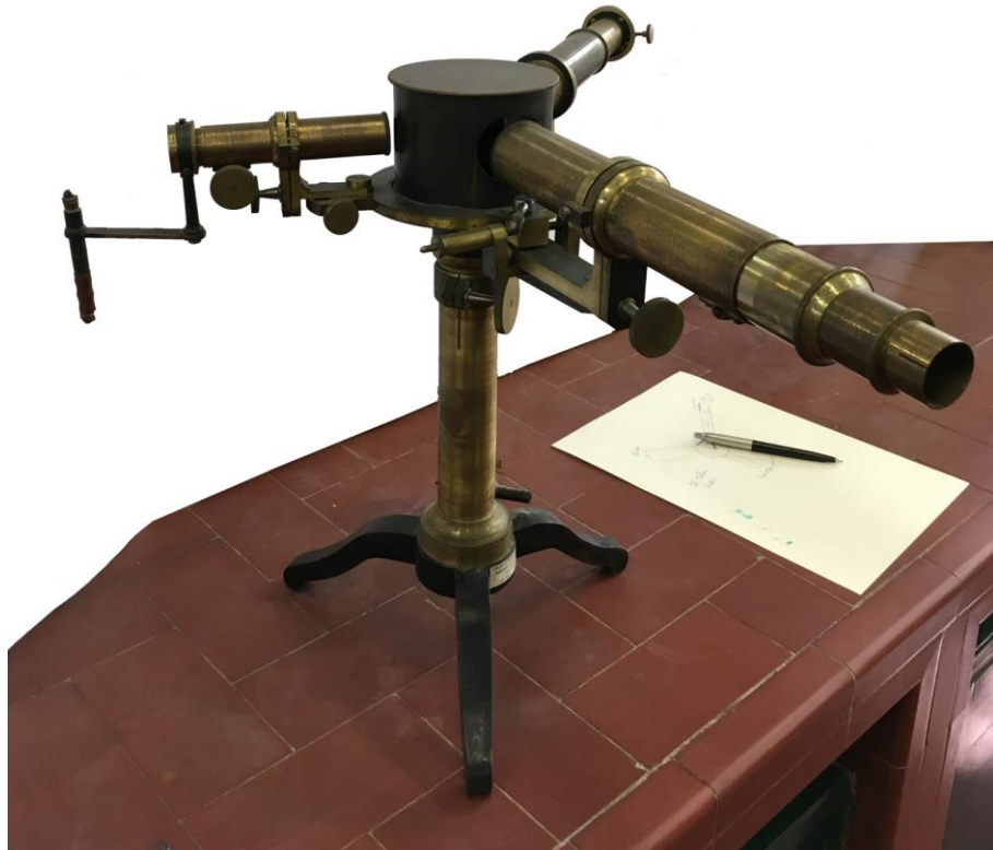
Figura 1 – Espectroscópio existente na coleção de instrumentos antigos didáticos e de investigação do Lab. Química, Inv. 1995, Nº 100, Instituto Superior Técnico.
