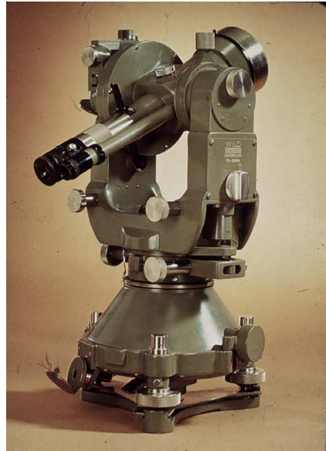
Teodolito Wild T3 largamente empregue para medição de ângulos na construção de redes geodésicas (até à década de 1980)
