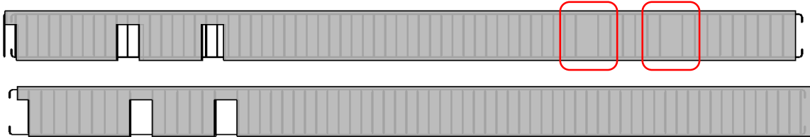
Figura 6.5 - Antes e depois de ser efetuado o ajuste manual das armaduras.
