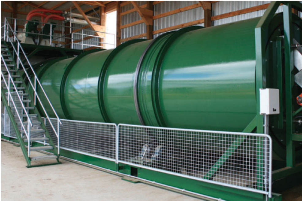
Figura 1 - Exemplo de um compostor industrial (Fonte:[8])
