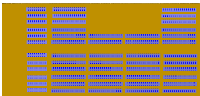
Figura 28 - Capacidade máxima instalável na cobertura - Desenho PVsyst
