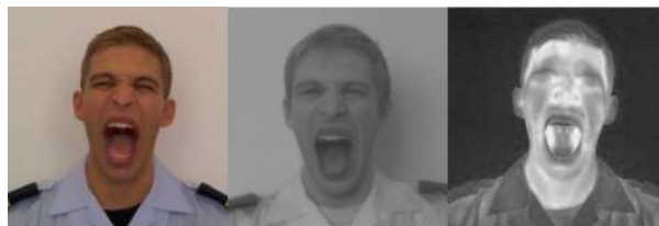
Figura 37 - Imagens utilizadas nos testes qualitativos do módulo de síntese de imagem nas bandas espectrais do Visível, NIR e LWIR.
