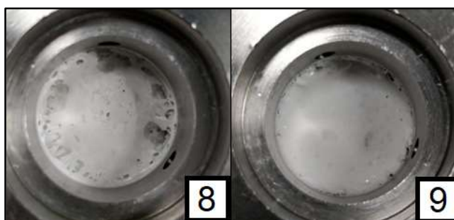
Figura 15: Membranas de PLI obtidas a partir de 1,0 mL de uma solução de 20% (v/v) a 40°C, 110 bar, despressurização em 4 minutos e processamento em 30 minutos com o acréscimo de duas admissões de 15 minutos: 8 - Pressurização em 1 minuto; 9 - Pressurização em 4 minutos.
