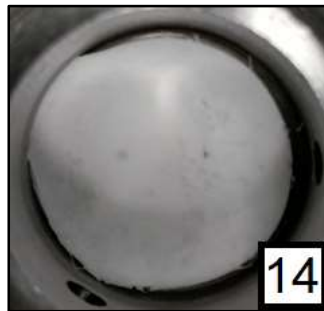
Figura 17: Membrana de PLI obtida a partir de 1,0 mL de uma solução de 10% (v/v) a 40°C, 110 bar, pressurização em 10 minutos, despressurização em 6 minutos e processamento em 20 minutos com o acréscimo de duas admissões de 10 minutos.
