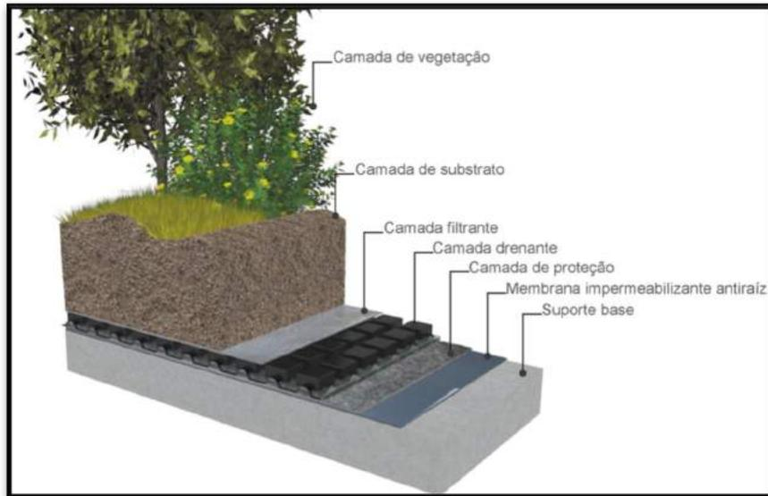
Figura 2.5 - Cobertura verde intensiva (adaptado de ANCV 2019)
