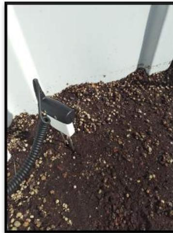
Figura 4.18 - Medição da humidade no substrato
