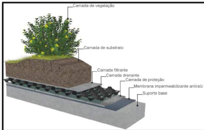
Figura 2.6 - Cobertura verde semi-intensiva (adaptado de ANCV 2019)
