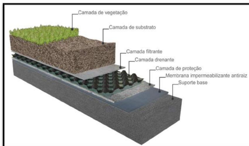
Figura 2.4 - Cobertura verde extensiva (adaptado de ANCV 2019)
