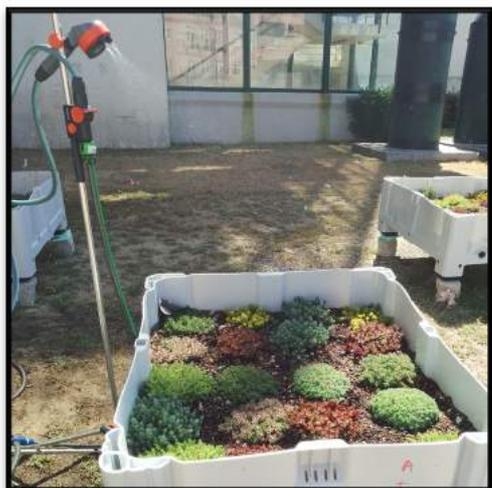
Figura 4.25 - Simulação de precipitação de baixa intensidade
