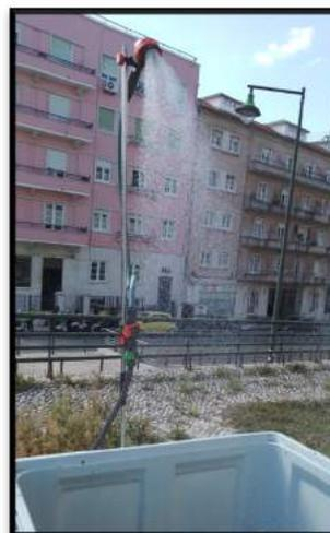
Figura 4.26 - Simulação de precipitação de alta intensidade
