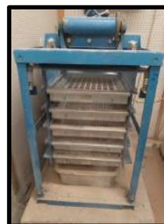
Figura 4.5 – Peneiração mecânica
