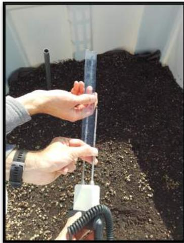
Figura 4.17 - Medição da espessura do substrato
