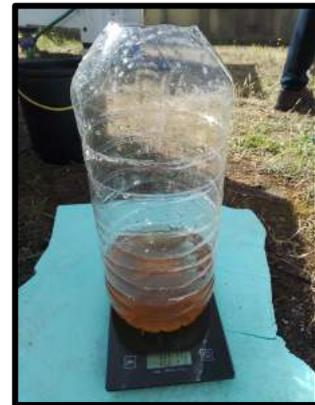
Figura 4.16 - Pesagem da água escoada pela cobertura
