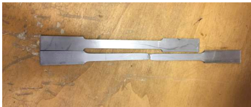
Figura 22 – Provete antes e após ensaio de tracção
