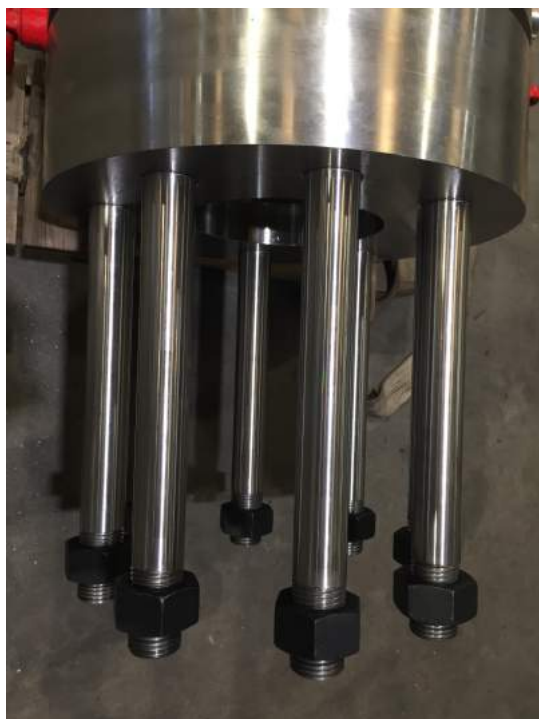
Figura 6 – Novos pernos após fabrico
