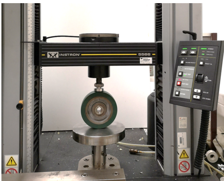
Figura C.1: Ensaio de compressão da roda, utilizando a máquina de ensaios INSTRON 5566
