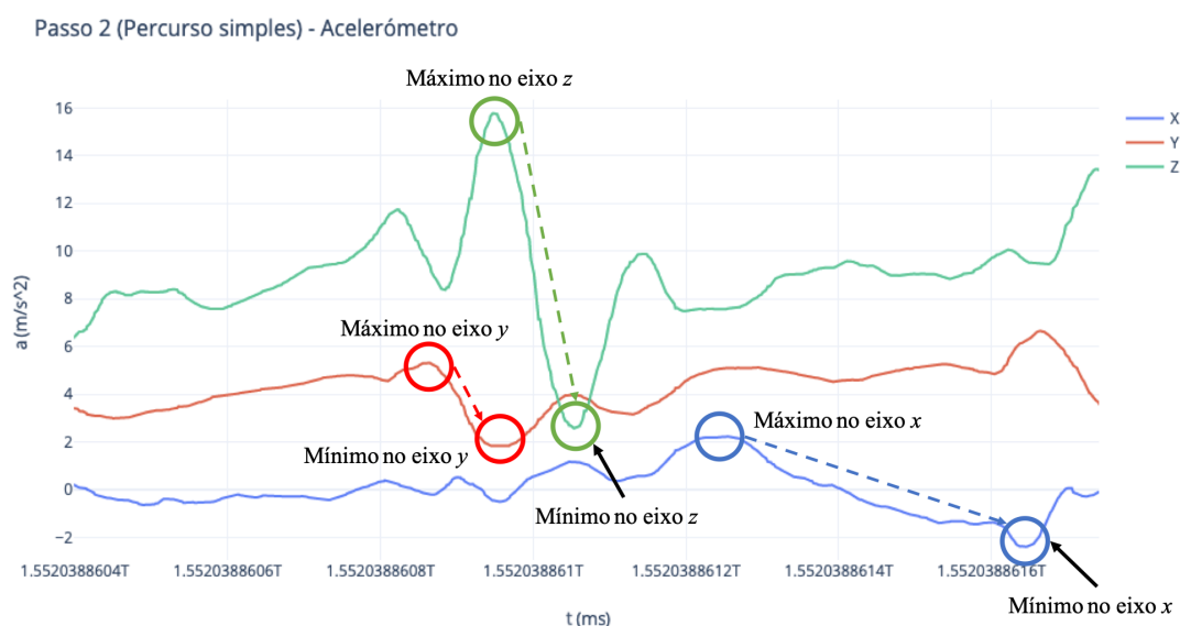
Figura 3.6: Gráfico traçado com as medidas do sensor acelerómetro, ampliando no segundo passo de modo analisar melhor a assinatura.
