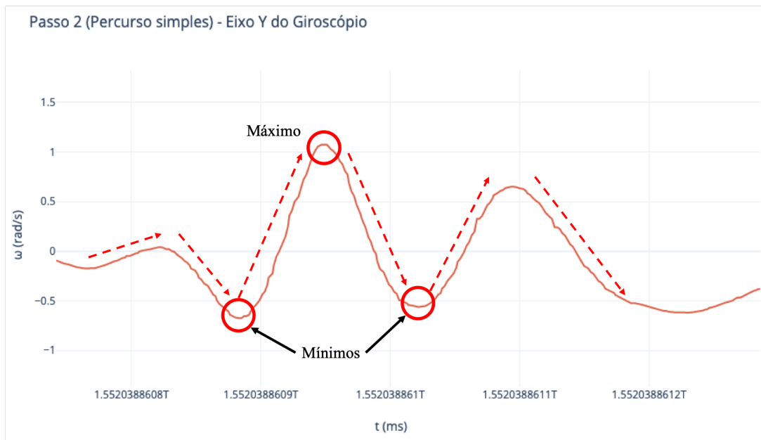
Figura 3.9: Gráfico traçado com as medidas do eixo y do sensor giroscópio, ampliando no segundo passo dado.
