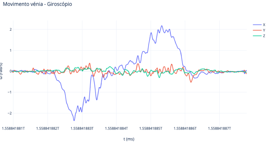
Figura 3.28: Gráfico traçado com as medidas do sensor giroscópio, durante a análise do movimento "vénia", em que o utilizar se debruça sobre algo.
