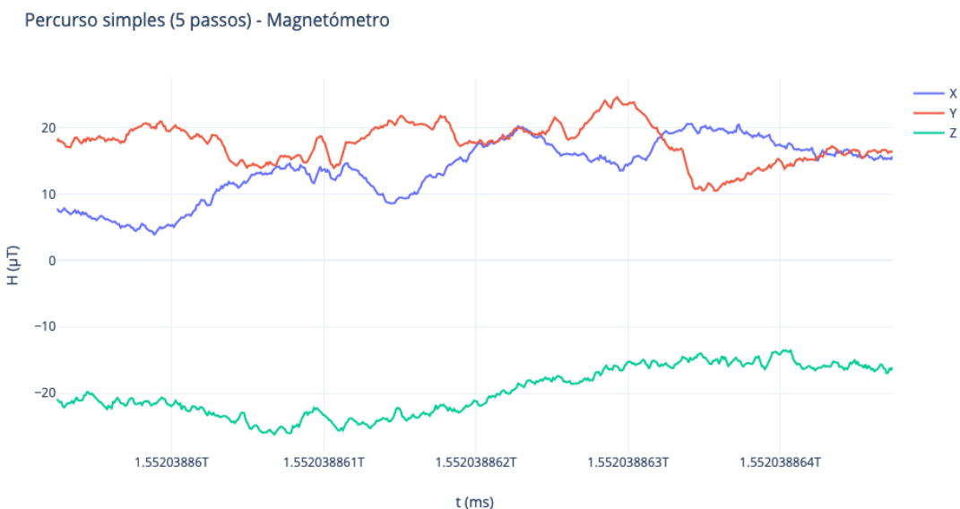
Figura 3.5: Gráfico traçado com as medidas do sensor magnetómetro, recolhidas durante o percurso simples com 5 passos.
