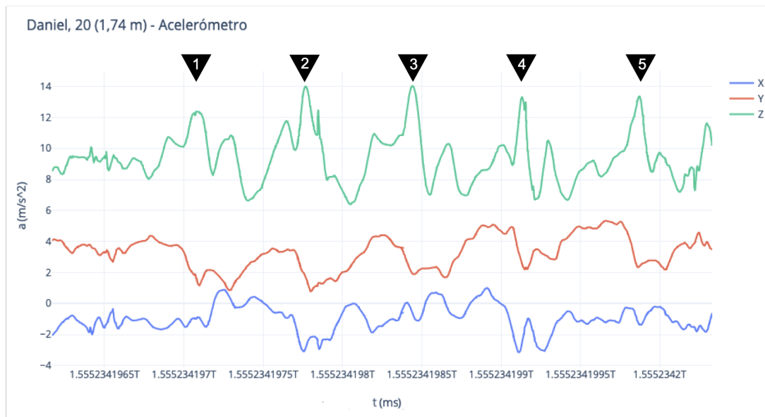
Figura 3.18: Gráfico traçado com as medidas do sensor acelerómetro, recolhidas durante o percurso de Daniel (20 anos), com as assinaturas dos passos identificadas.
