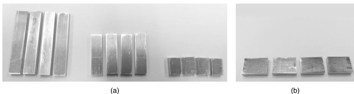
Figura 3.9 – (a) Provetes de largura w_0 = 10 \text{ mm} para ensaios CCF, CCLF e CCL; (b) Provetes de largura w_0 = 20 \text{ mm} para ensaios CCL.
