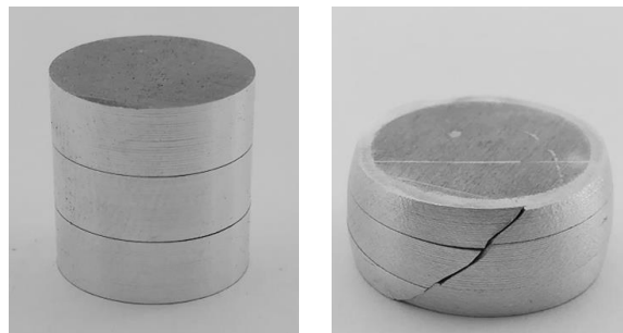
Figura 3.3 - Provette de CDE antes (esquerda) e após (direita) o ensaio.
