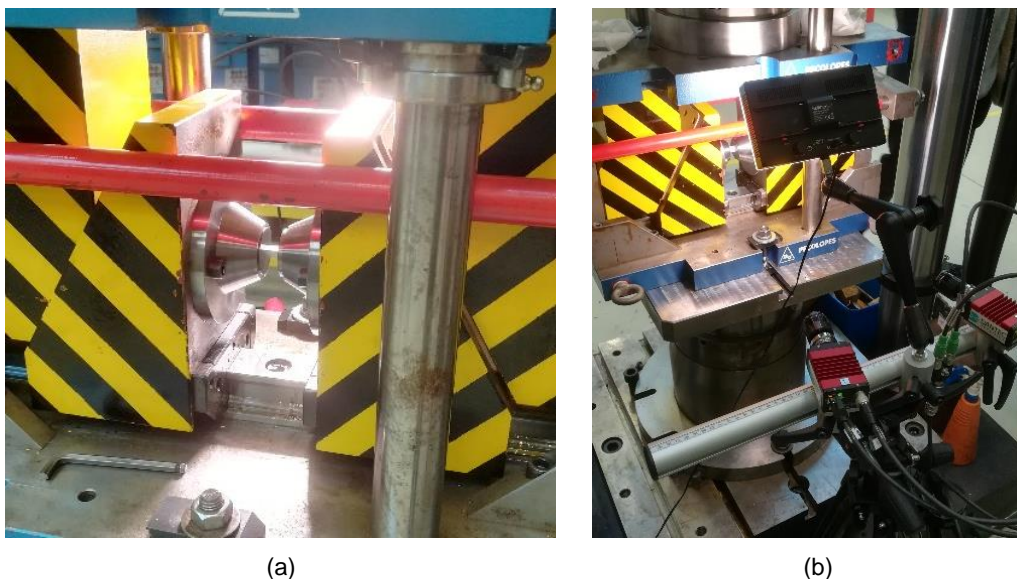
Figura 3.8 – (a) Ensaio de compressão longitudinal de chapa; (b) Sistema digital de correlação de imagens em funcionamento para um ensaio de compressão longitudinal de chapa.
