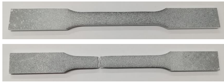
Figura 3.1 - Provete de tração antes (acima) e após (abaixo) o ensaio.
