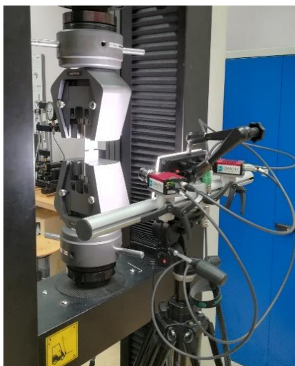
Figura 3.18 - Sistema digital de correlação de imagens em funcionamento durante um ensaio de DNT.
