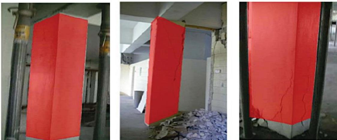
Figura 50 - Resultados da detecção de colunas em estruturas de betão armado [59][60].
