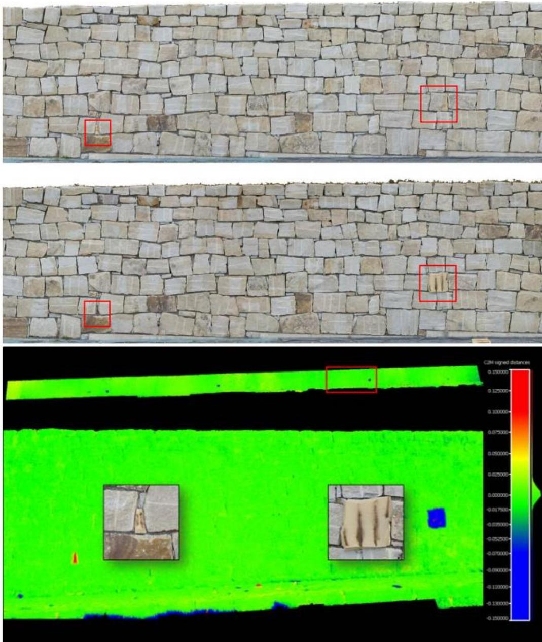
Figura 47 - Detecção de alterações comparando a nuvem de pontos das duas imagens acima, com recurso ao software *CloudCompare*, em cima: fotografias recolhidas de duas campanhas de inspeção, em baixo: comparação da nuvem de pontos [56].
