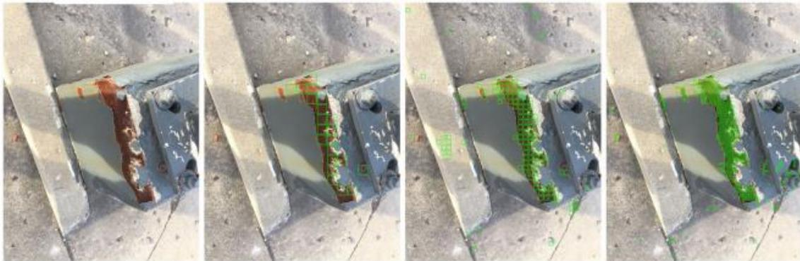
Figura 43 - Detecção de corrosão utilizando ZF Net aplicada a imagens RGB, em que as caixas verdes representam regiões corroídas [53].
