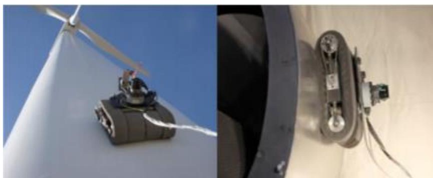
Figura 55 - Exemplos de aplicações do robô ICM Climber [64].
