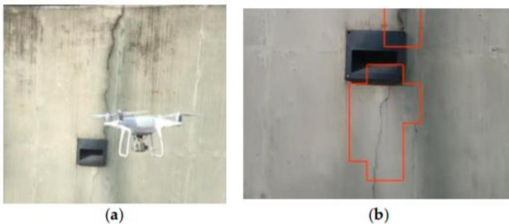
Figura 42 - Detecção de fissuras em tempo real utilizando um drone: (a) captação de vídeo pelo drone; (b) exemplo da detecção de fissuras em tempo-real [52].
